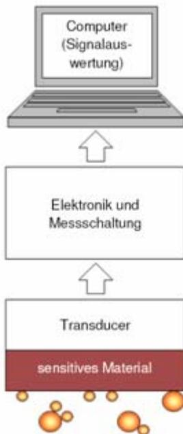
Abb. 4: Chemosensor-Prinzip
