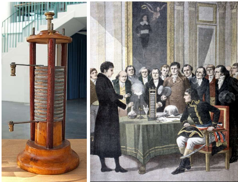
Abbildung 1: Links: Volta'sche Säule bestehend aus Zink- und Kupferplatten getrennt durch in Elektrolyten getränktem Stoff. Als Elektrolyt wurde z.B. verdünnte Schwefelsäure verwendet. 2 Rechts: Volta bei der Präsentation seiner Erfindung bei Napoleon. 3
